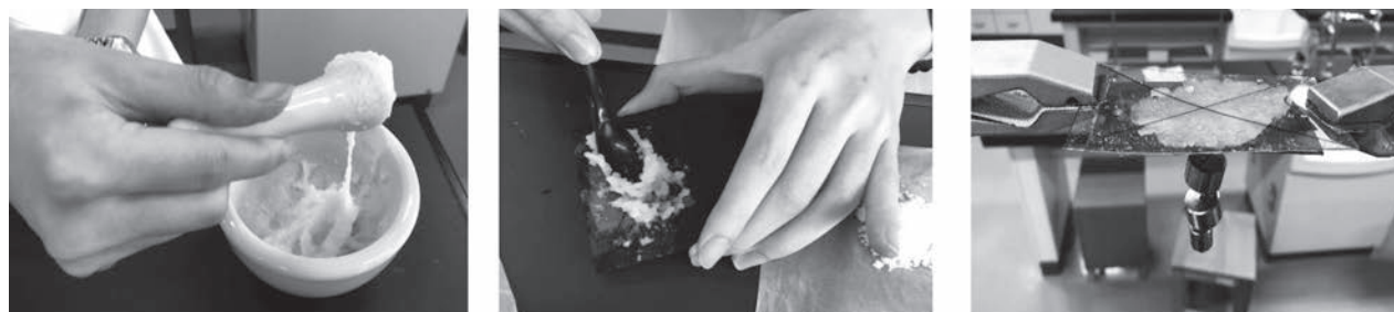
図1 実験装置作成手順（左：お米をつぶす、中央：プラスチック板につける、右：スタンドに挟む）
