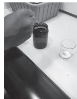
ポリ酢酸ビニルと炭酸カルシウムを混ぜている様子
