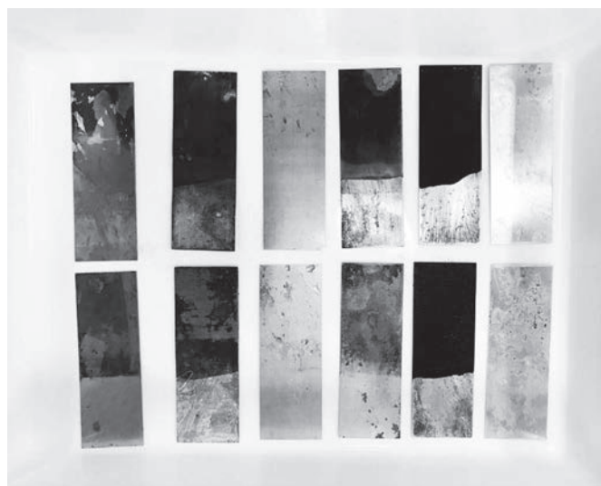
図2 電流が流れた後の正極板 (左から順にCu, Pb, Ni, Fe, Zn, Al 上は①, 下は②)
